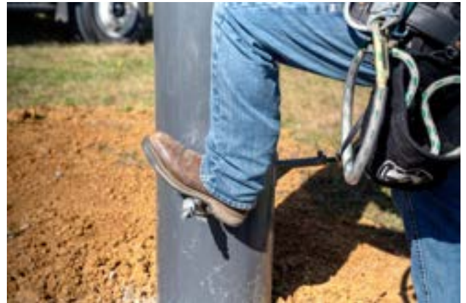
FIG. 8.3. Pole step test
